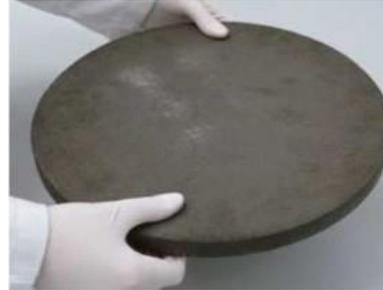
Composite à base d'Hydrures de magnésium contenant 600 litres d'hydrogène
