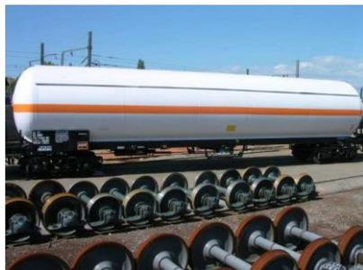
Les wagons transportant des gaz liquéfiés (GPL et autres) sont repérés par une bande orange de 30cm de largeur qui entoure le réservoir à mi-hauteur.
