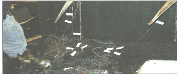
Figure 14.30 Chaque point de passage d'un arc dans ce câblage a été identifié par une étiquette numérotée. Photo fournie par Yates & Associates.
