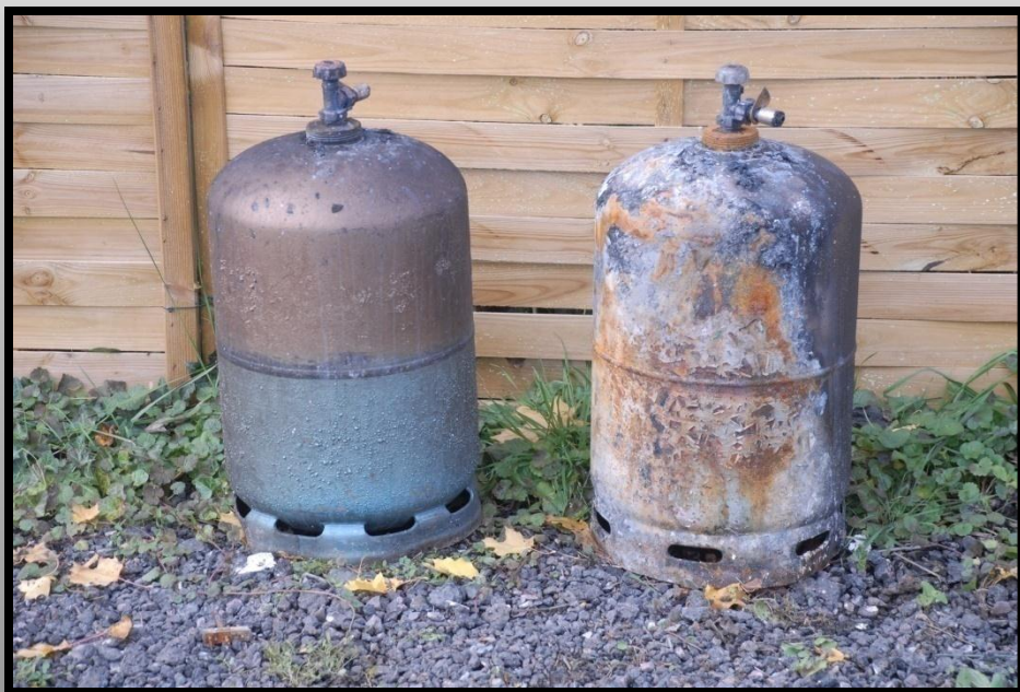
Figure 1.9 Variation de la couleur de l'acier en fonction de la température de revenu
