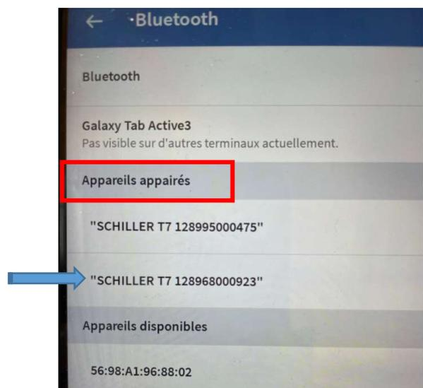
Lorsque l'appairage est réussi, votre moniteur apparaît dans « **Appareils appairés** »
