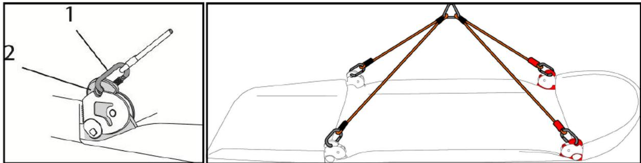
La pantoire doit être reliée au dispositif de traction par le maillon delta triangulaire central. Bien vérifier la bonne fermeture de ce maillon rapide.
