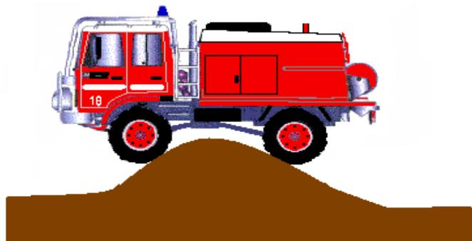
Franchissable dans la limite des angles d'attaque, de fuite et de rampe.
