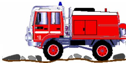
Attention aux pierres saillantes (si impossibilité de contourner, franchir avec la bande de roulement du pneumatique, partie la plus solide).
