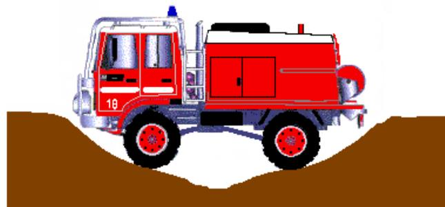
Franchissable dans la limite de l'angle de fuite et de l'angle d'attaque.
