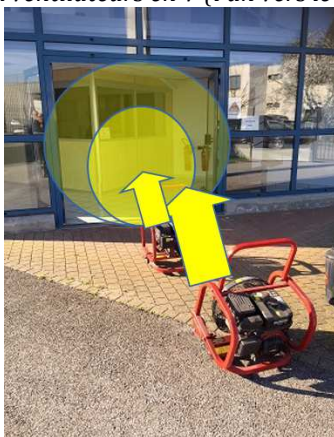
Illustration n°5 : Utilisation de deux ventilateurs l'un derrière l'autre
