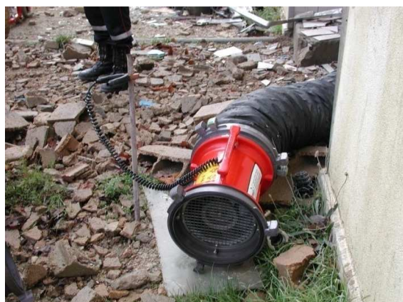
Illustration n°2 : Utilisation d'un hydro ventilateur
