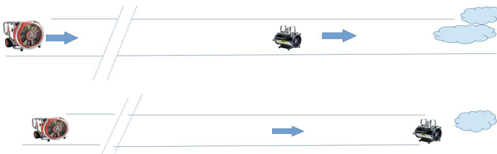
Illustration n°8 : Principe d'utilisation de ventilateurs en relais
