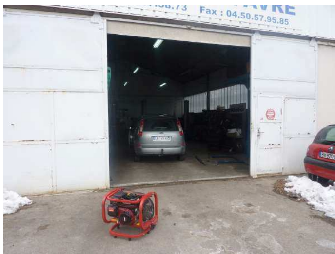
Illustration n°1 : L'orientation du ventilateur peut permettre un meilleur brassage de l'air à l'intérieur et de limiter le recyclage des fumées
