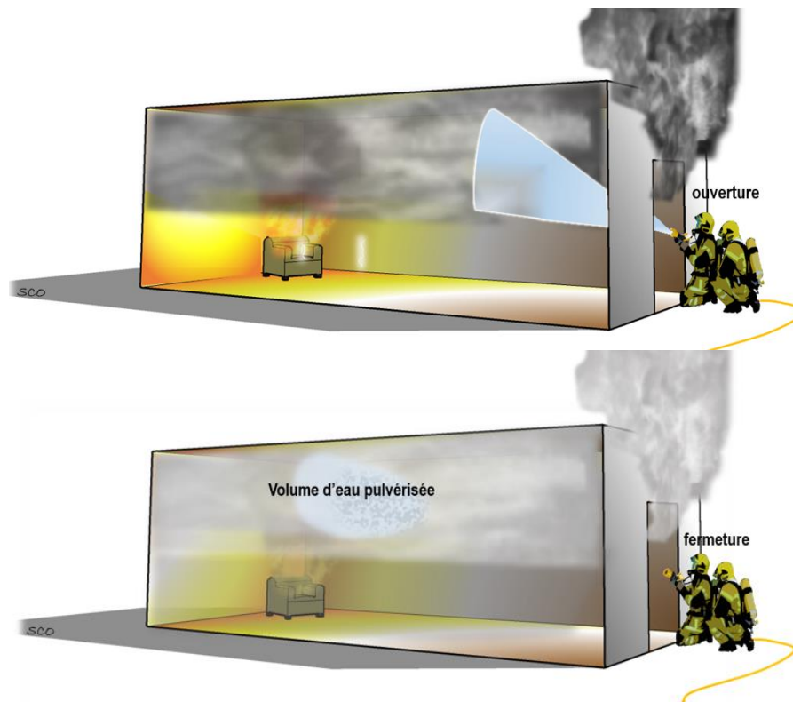
Schéma n° 1 : principe de l'impulsion
