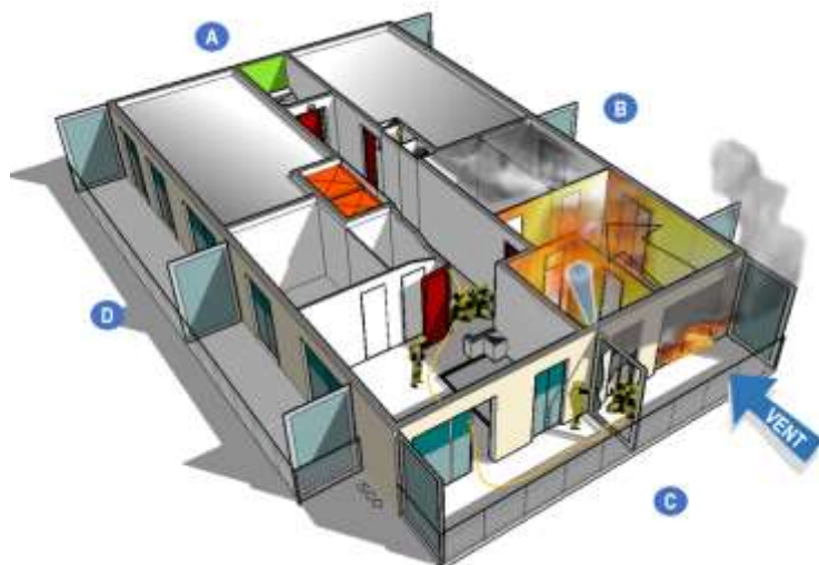
Schéma n°5 : feu démarré sur un balcon avec rupture de la fenêtre et porte de l'appartement ouverte
