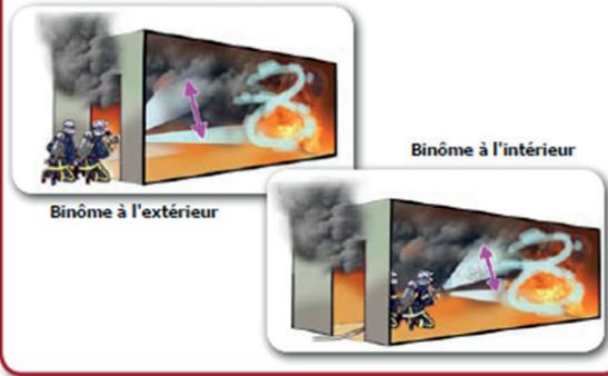
L'utilisation d'une quantité d'eau importante en fines gouttelettes permet d'absorber une quantité d'énergie importante.
