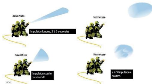
Les impulsions longues (long puls) consistent en une ouverture rapide sur l'ouverture du robinet de la lance puis 2 à 5 secondes env., en une fermeture progressive. Cette technique est à privilégier dans des structures type magasins, entrepôts, atriums, garage, etc... Elle sera aussi à appliquer lors des passages de portes pour sécuriser l'ambiance derrière la porte.
