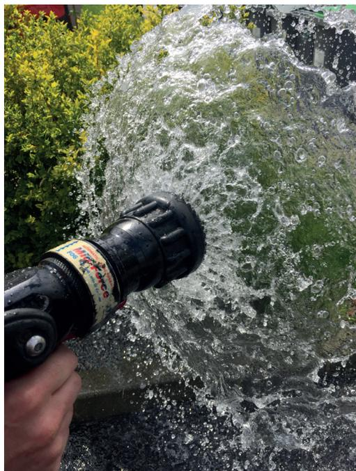
Sert à purger la ligne d'attaque très rapidement en abaissant la pression à la lance permettant de libérer ou chasser des impuretés entre le boisseau et la soupape de régulation et de procéder au noyage d'un foyer lors d'un déblai.
