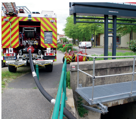
Mettre la ligne d'aspiration à l'eau et effectuer l'aspiration.
