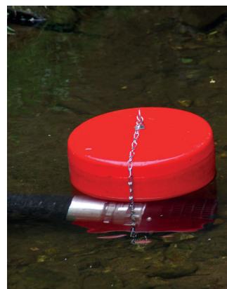
Mettre la ligne d'aspiration à l'eau et effectuer l'aspiration.
