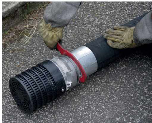
Raccord de la crépine à un tuyau d'aspiration.
