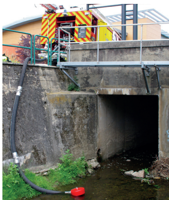
Mettre la ligne d'aspiration à l'eau et effectuer l'aspiration.
