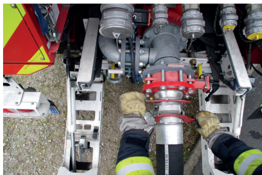
Raccord de la ligne d'aspiration à l'EPT.
