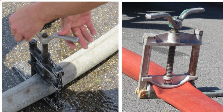
Positionner l'étrangleur puis serrer le tuyau en tournant la manivelle.
