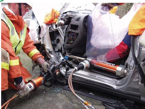
Durant la phase d'intervention sur les structures ou à proximité des personnes la couverture de protection doit être positionnée sur les personnes (victime + sapeurs pompiers). La fenêtre PVC placée sur les individus permet une certaine luminosité et un certain confort tout en étant isolé et protégé.
