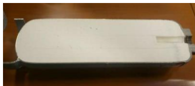
Coupe d'une bouteille d'acétylène
