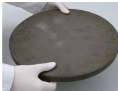
Composite à base d'Hydrures de magnésium contenant 600 litres d'hydrogène
