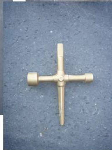
Clés de barrage des canalisations avec OCG enterré (canalisation basse pression)
