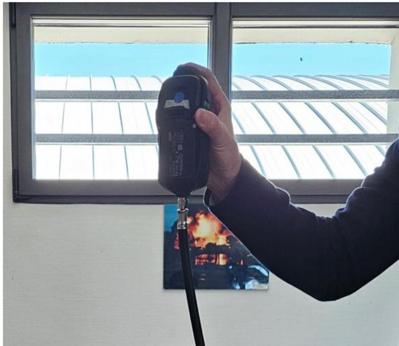
**Répéteur WIFI :** permettant d'augmenter la distance d'utilisation du module M1 connecté au TGR,
