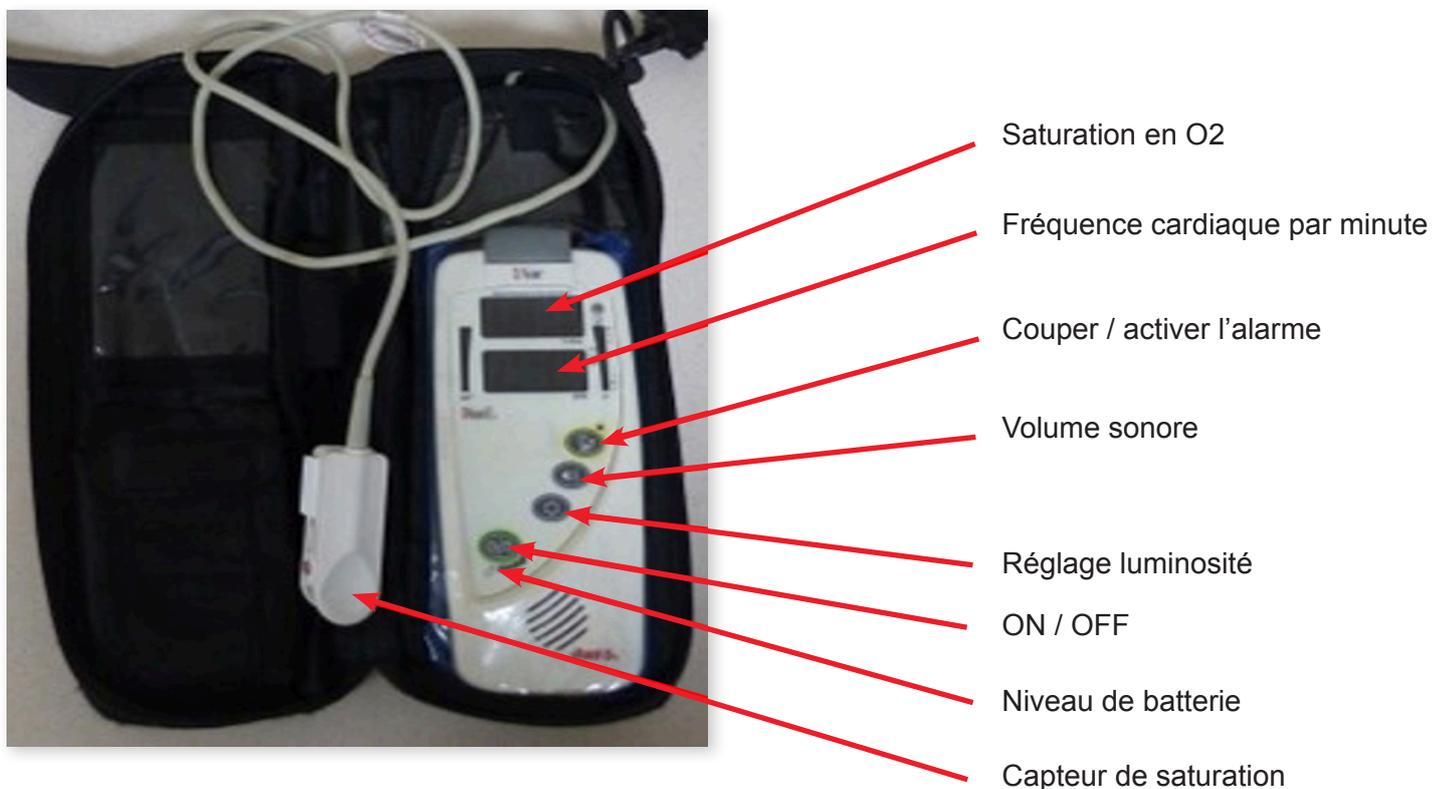
L'oxymètre de pouls est un appareil électronique qui mesure la longueur d'onde de la couleur rouge qui reflète la quantité d'oxygène transportée par le sang exprimée en %.
