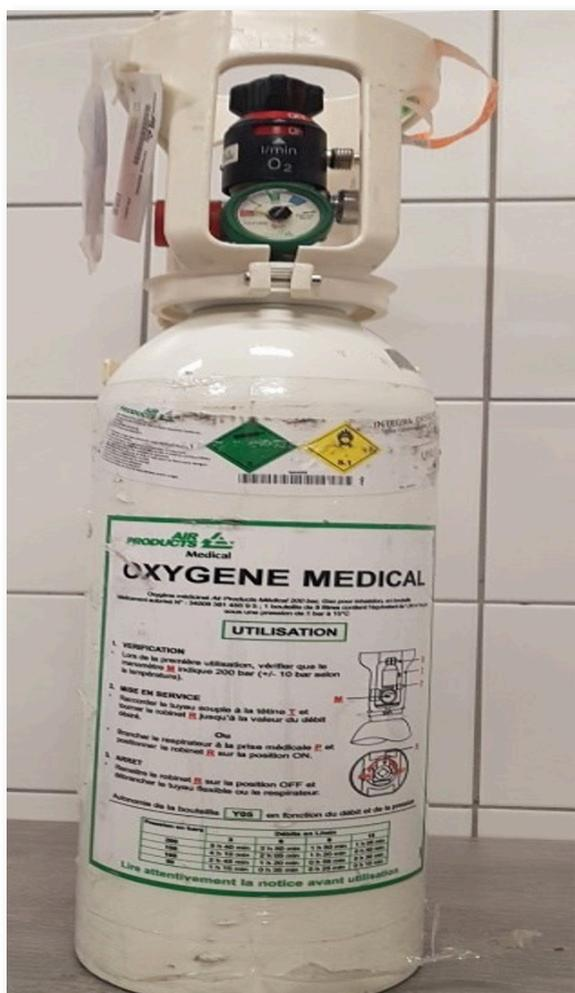
Les bouteilles sont blanches, en matière composite, légères, équipées d'une poignée de transport, d'une gaine de protection (assurant la non-contamination du gaz) et d'un chapeau inamovible derrière lequel se trouve un système de détente et de débitmètre intégré.
